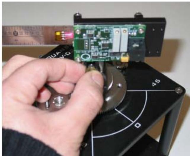
Figura 2. Pormenor do extensómetro (colado sobre a barra)
