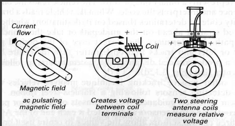
O fio condutor gera o campo magnético através da corrente alternada que passa por ele
