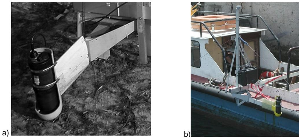
Figura 4 – O pré-protótipo do IRIS. a) Detalhe da sonda acústica de feixe estreito com varrimento mecânico ; b) Aspecto do IRIS montado numa embarcação de apoio do porto de Sines.
